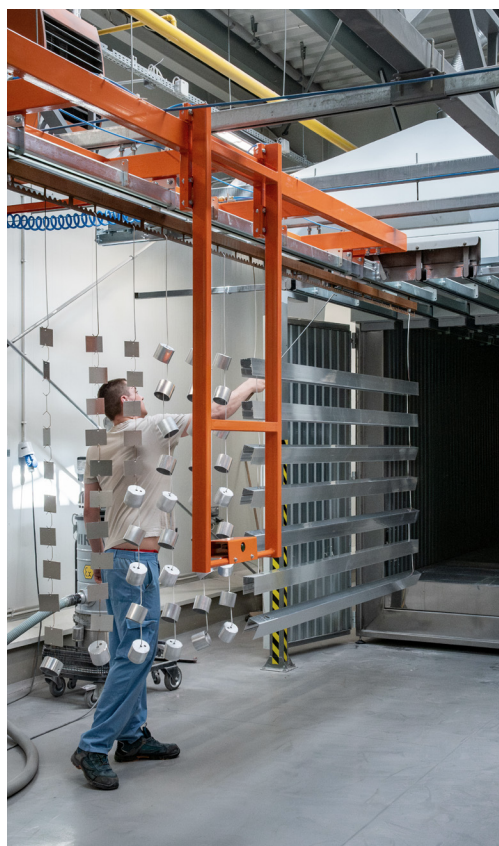
Fot.5. Ilustracja usprawnionego procesu wprowadzania partii produkcyjnej do pieca, realizowanego za pomocą szynowego systemu transportowego.
