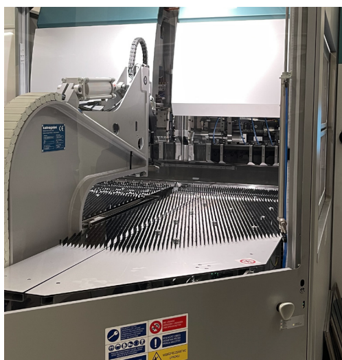
Fot.8. Zautomatyzowane, precyzyjne centrum gięcia CNC, w pełni operacyjne od 2024 roku, stale napędzające optymalizację przepustowości w naszym zakładzie produkcyjnym w Załuskach.
