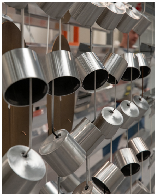
Fot.4. Proces produkcji aluminiowych opraw oświetleniowych w zakładzie Spectry.
